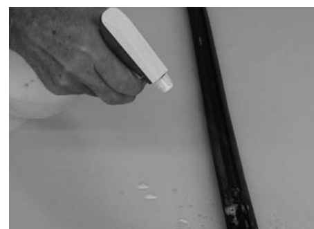
Besprühen des Dichtungsfusses mit Seifenwasser
